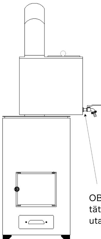
OBS! Vattenkranens tätning bör vara utanför tanken
